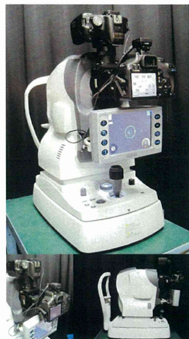
図2 新しく開発した網膜酸素飽和度測定装置
