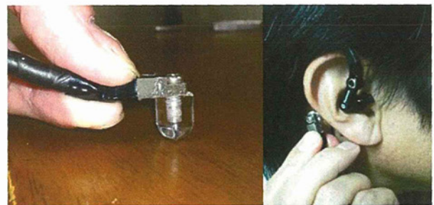
図3 テストロッドでの聴覚試験
