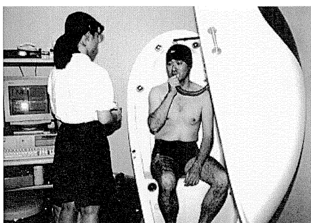
図 1 空気置換法による体脂肪率測定
