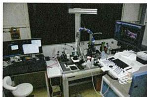
超音波計測連成血流解析システム
