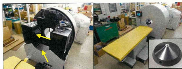
図4 デジタル回路が搭載された高解像度SPECT装置。左図：装置内部、右図：全体外観、右下：局所拡大撮像用ピンホールコリメータ
