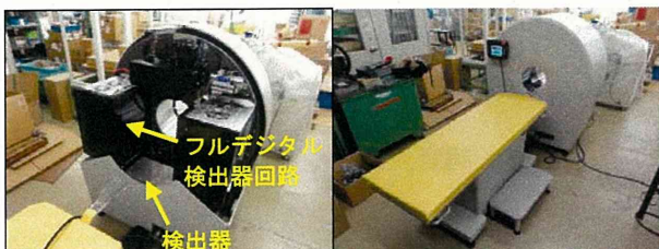
図3 デジタル回路が搭載された高解像度SPECT装置。左図：装置内部、右図：全体外観
