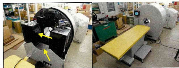
図2 デジタル回路が搭載された高解像度SPECT装置。左図：装置内部、右図：全体外観
