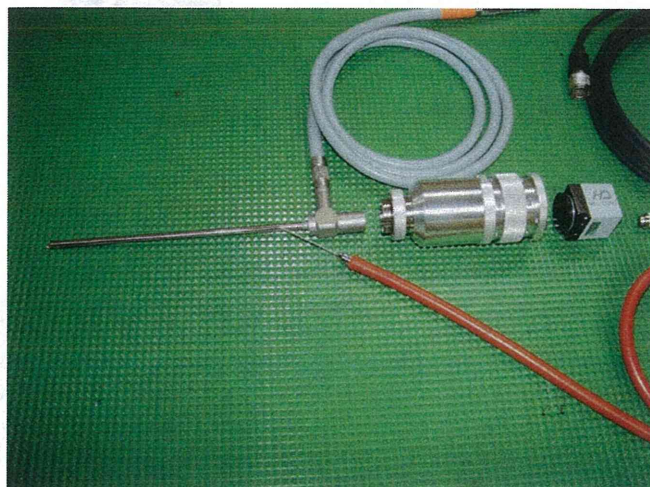
図 1 2 新型カメラアタッチメントおよび CMOS ハイデフィニションカメラ、光源ファイバーの全体像
