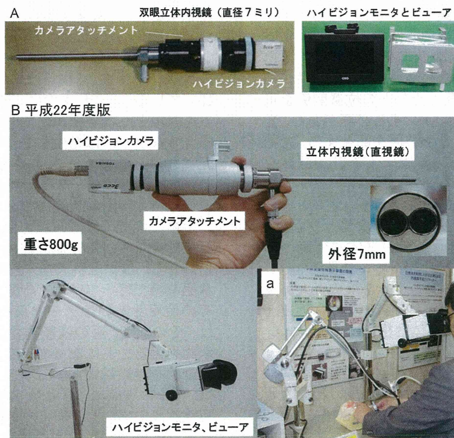
図2 研究開発の基盤となった立体内視鏡(A)と平成22年度版改良機(B)
