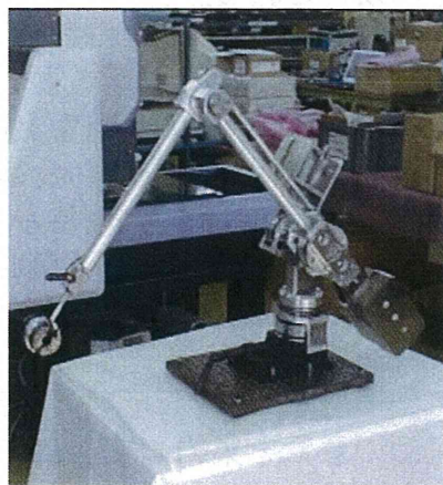
図 20 電磁ロック式内視鏡支持アーム
