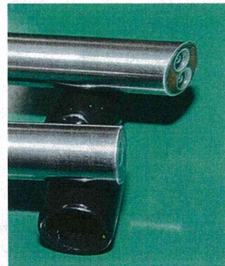
図8 試作双眼斜視鏡 平成22年度に試作した30度斜視鏡（上）と直視鏡（下）。斜視鏡では光軸と照明の軸の調整がきわめて困難であった。
