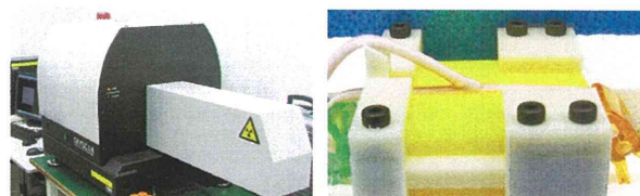
図1 マイクロCTによる血管吻合の3次元内腔計測（左：卓上マイクロCT, 右：縫合された血管モデル）
