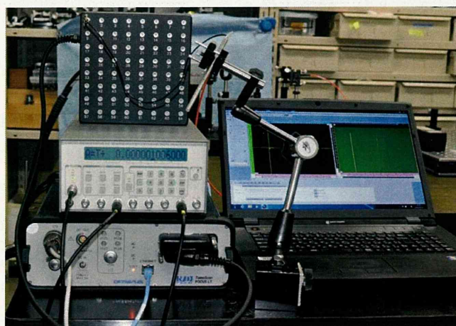
図 5 多チャンネルパルサーレーザーへの自作探触子の接続。アレイ型探触子用の接続端子を専用アダプタにより最大 64 個の Lemo00 コネクタに変換し、そのコネクタに P(VDF-TrFE)製の自作探触子(単素子)を接続している。
