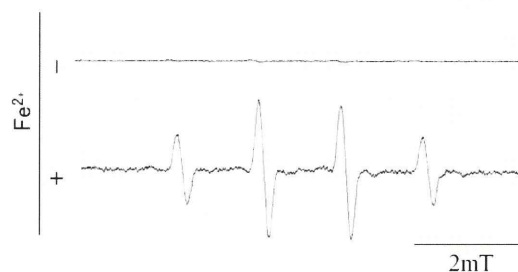
図7 TiO x ナノ粒子とFe 2+ との反応、ESRによる測定
