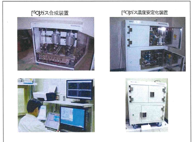
第19図-1 医療機器申請を前提に製造された迅速ガスPET対応型の ^{15}O -標識ガス自動合成・供給システムの外観。
