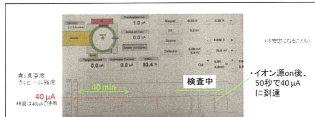
第22図 今回利用する 15 O-生成専用の超小型サイクロトロンにおける出力電流の時間依存。十分なビーム電流により十分な放射性ガスの供給が可能であることが確認された。
