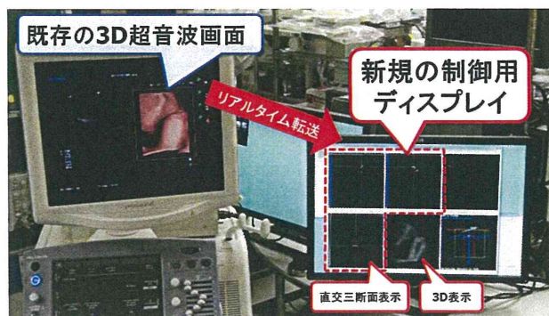
Fig. 4 3D 超音波ボリュームデータのリアルタイム転送とグラフィカル表示。
