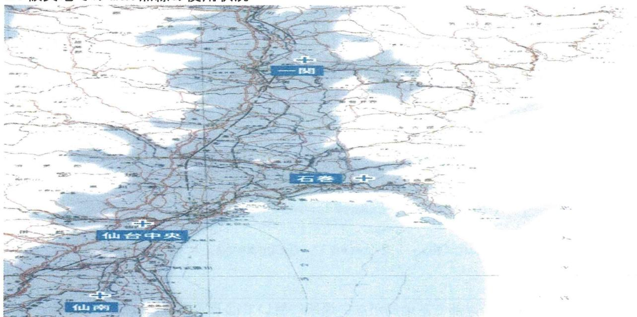
MCA 無線は各基地局から 20km～40km 範囲で使用可能であり、各基地局は電気通信事業者から借りている専用回線で結ばれて広範囲での通信が可能。
