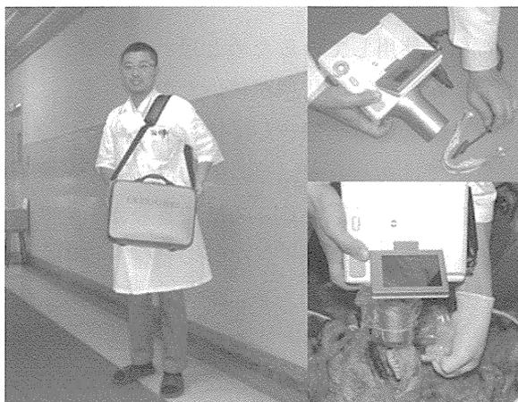
図 3. 充電式携行型の歯科用デジタルエックス線撮影装置。撮影装置：デキシコ ADX4000 (10DR JAPAN)。鑑定例の写真は、東日本大震災とは無関係である。
