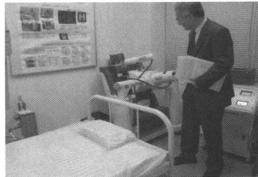
(写真右)椅子型ホールボディーカウンタ
