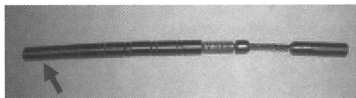
図 2、線源容器内に格納されたイリジウムホルダー長さ約 17cm×径約 0.7cm)。左端に径約 2mm×厚約 2mm のイリジウムが密封されている
