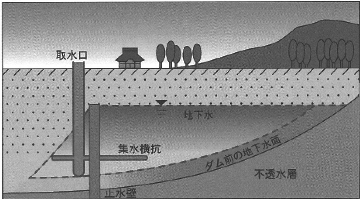
図2 地下ダム模式構造図
