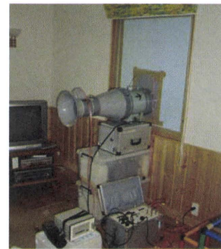
写真2 気密測定の様子
