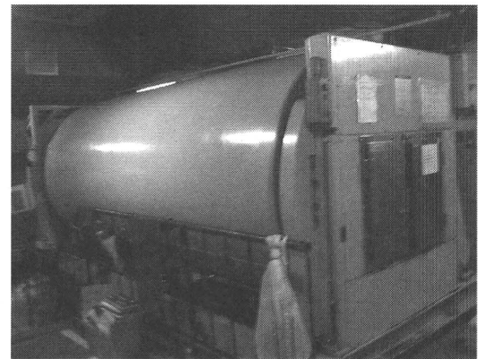
写真 1-6-6 ドラム圧縮式廃棄物処理機
