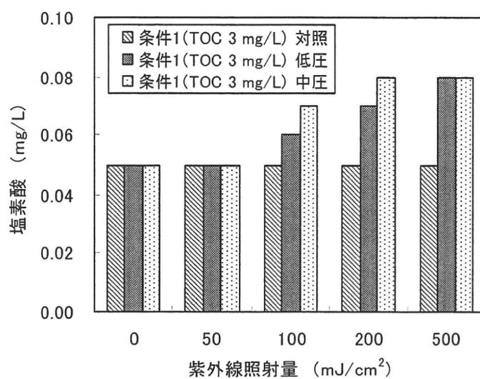
図7 紫外線照射による塩素酸の生成 (条件1)
