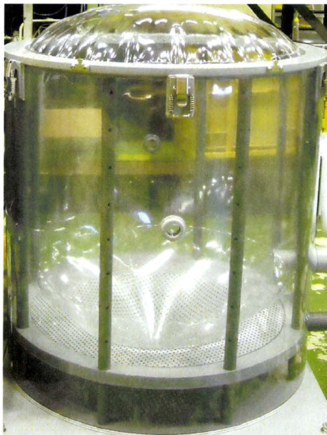
写真 2. 開発製造した、ディスプレイブル暴露チャンバー(左写真は外筒、右は蓋)
