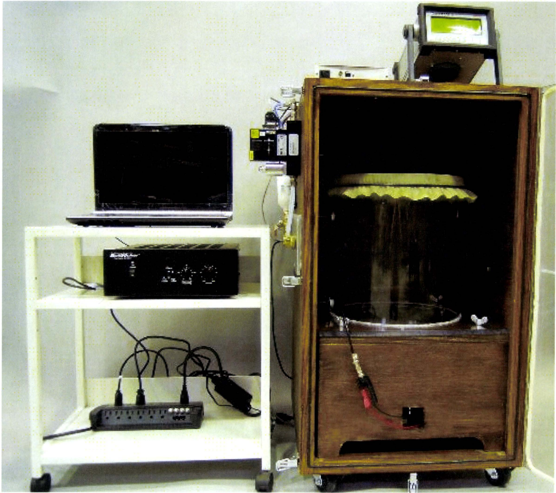
写真 1. McKinneyら 1) の開発したスピーカーによる音振動を用いた発生器
