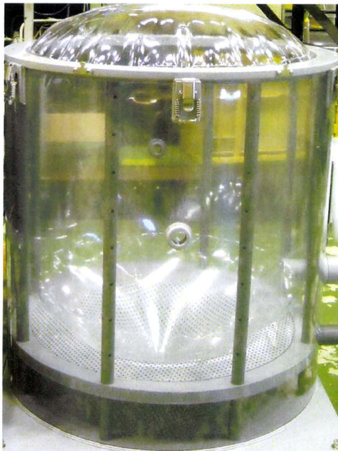
写真 2. 開発製造した、ディスプレイダブル暴露チャンバー(左写真は外筒、右は蓋)
