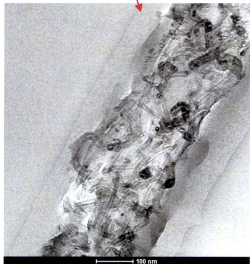
図7-a,-b,-c CNT コーティング糸の TEM 観察像
