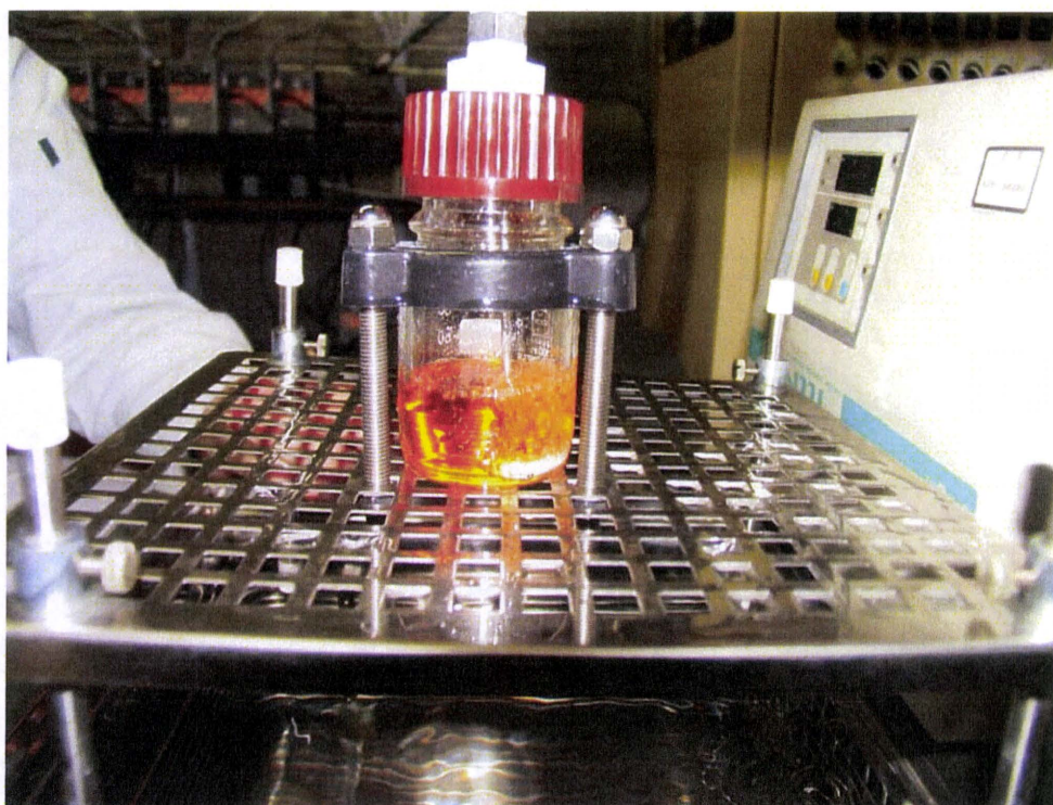
図 ダイアジノン-4 ゴアテックスチューブによるダイアジノンの気泡の発生状態
