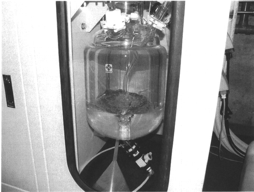
図 テトラデカン-2 テトラデカン蒸気の発生装置
