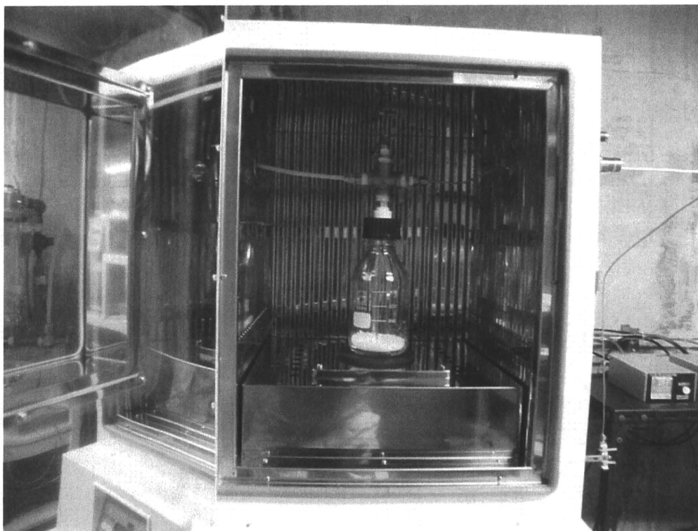
図 パラジクロロベンゼン-4 恒温槽 (27°C) に収納したパラジクロロベンゼン発生容器
