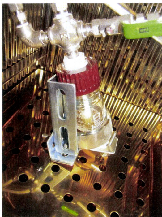
図 クロロピリホス-3 クロロピリホスの発生容器 (50℃に加温した恒温槽内に設置)
