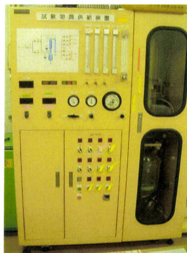
Photo. 2 バブリング式発生器(柴田科学) DEHPの Maus への暴露濃度を、室内汚染化学物質の室内濃度指針値である 7.6\text{ ppb} から、低濃度を 7.6\text{ ppb} とし、公比3で 25, 76\text{ ppb} と目標とした。
