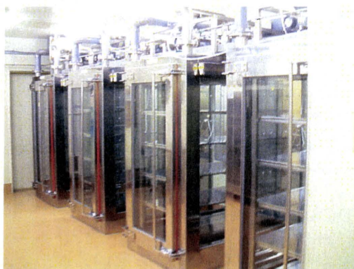
Photo. 1 大型横層流暴露チャンバー (容積 3\text{m}^3 、柴田科学)
