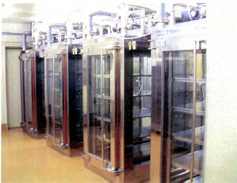
Photo. 1 3m 3 横層流大型チャンバー(柴田科学)
