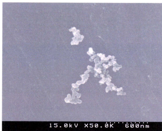
図 2.37 ヒュームドシリカ粒子の FE-SEM 観察像（×50,000）
