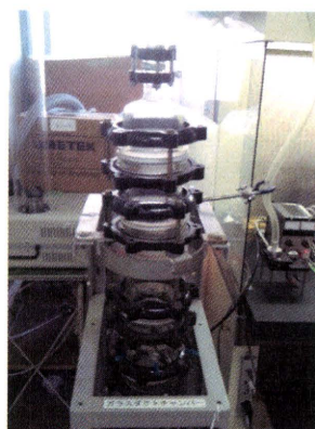
図 2.16 ガラスダクトチャンバーの外観
