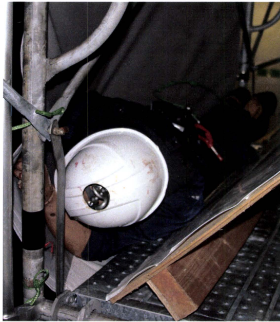
写真 41 Type-1 の実験後の状況 (墜落防止された)
