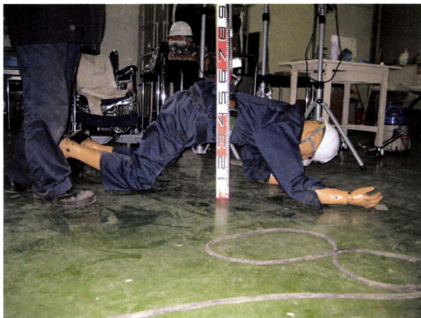
写真7 実験に用いた人体ダミーの落下姿勢
