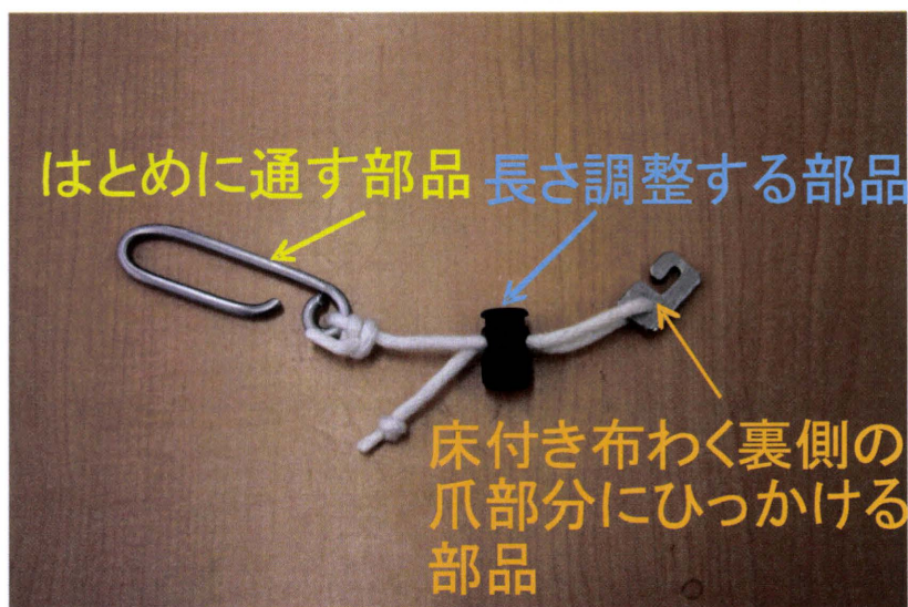
写真36 新たに考案した取付金具 (Type-1モデル)
