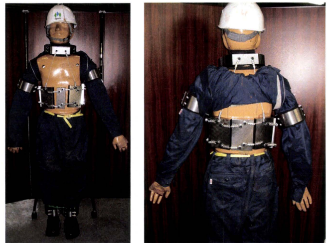
写真8 錘を取り付け 100kg とした人体ダミー
