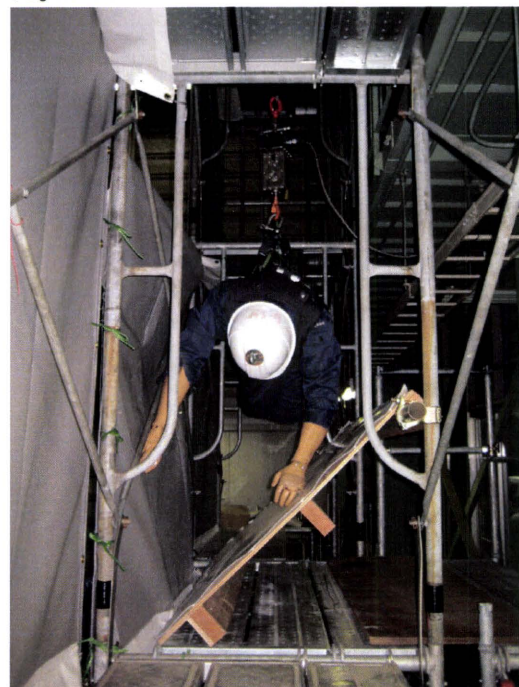
写真9 人体ダミーの落下高さ (1000mm)
