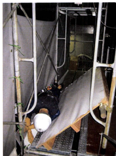
写真5 実験後の状況(落下せず)
