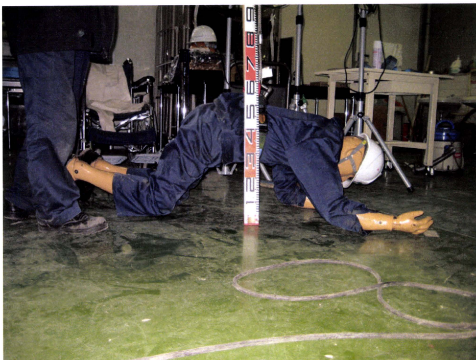
写真8. 実験に用いた人体ダミーの落下姿勢
