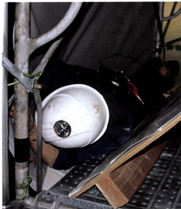
写真 10. 実験 1 の実験後の状況 (墜落防止された)
