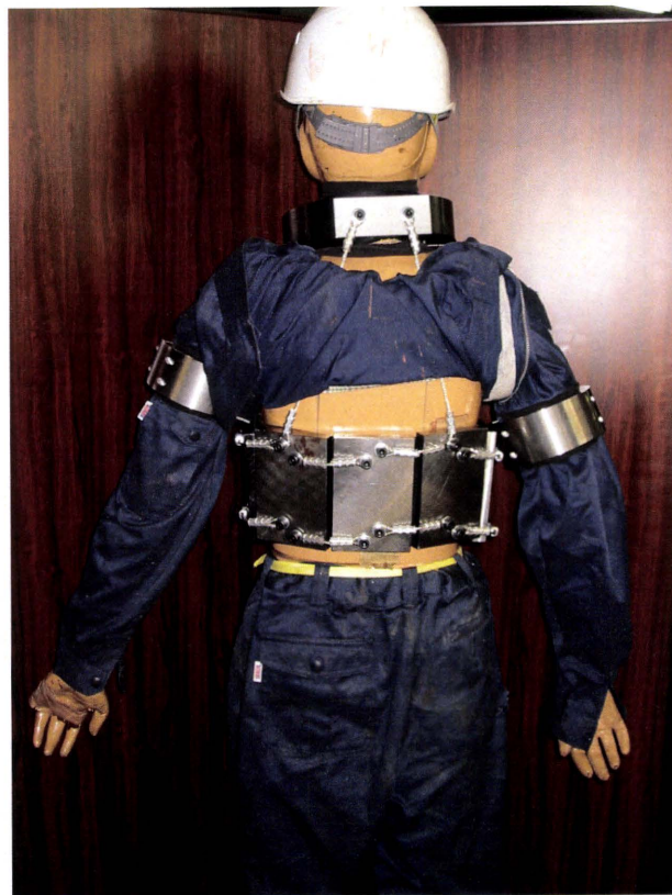
写真7. 付加錘を取り付けた人体ダミー (85kgの人体ダミーを100kgとしたもの)
