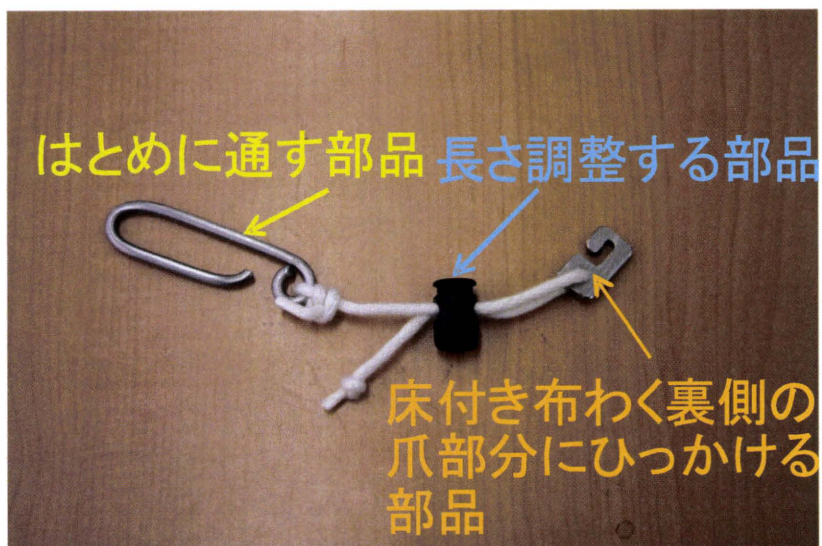
写真3. 新たに考案した取付金具 (Type-1 モデル)
