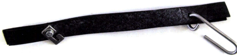
写真 5. 新たに考案した取付金具 (Type-2 モデル)
