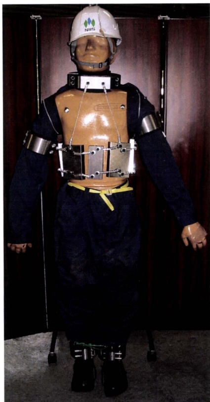
写真7. 付加錘を取り付けた人体ダミー (85kgの人体ダミーを100kgとしたもの)
