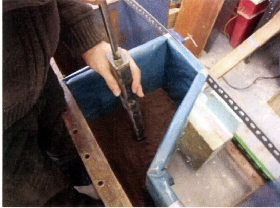
図-7.6 模型地盤の締め固め状況
