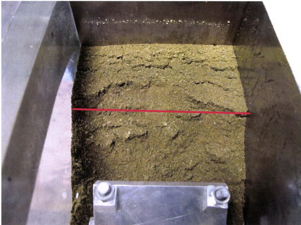
図 6.34 Case2 実験後の天端状況
