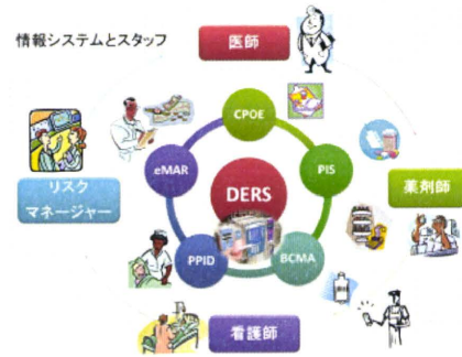
図2 Dose error reduction systemsの構成 HISの構成要素として電子オーダーシステム: Computer Physician Order Entry (CPOE)、薬剤情報システム: Pharmacy Information System (PIS)、バーコード投薬管理システム: Bar Code Medication Administration (BCMA)、患者認証システム: Positive Patient Identification (PPID) や電子診療記録システム: Electronic Medical Record (EMR) などがある。これらを有機的につなげることで輸液ポンプの設定間違いを検出し医療事故の発生を未然に防ぐことができる
