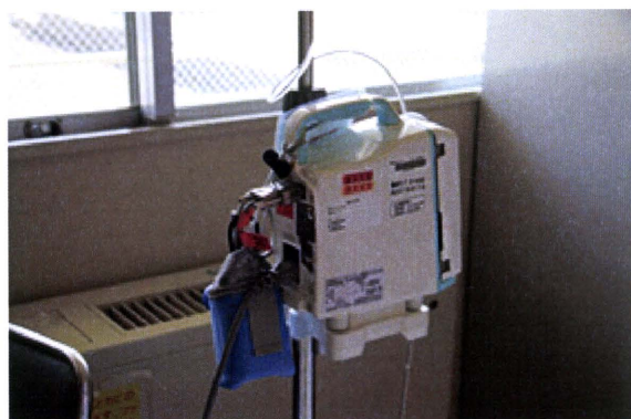
図1 ZigBee 無線通信機能を有する超小型無線端末を輸液ポンプに取り付けた状態
