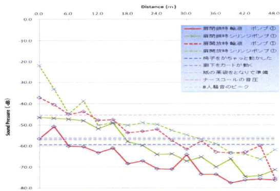
Fig. 27 ポンプとドア開閉状態の距離による警報音圧の低下とナースステーション内の騒音レベル (横破線)
