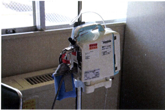
Fig. 8 ZigBee 無線通信機能を有する超小型無線端末を輸液ポンプに取り付けた状態
