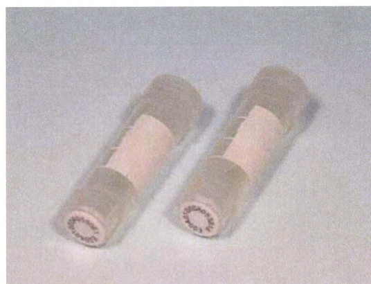
図2. セラミック製ICタグ付試料容器
