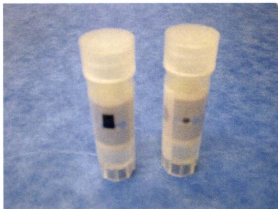
図3. シール IC タグ付試料保管容器 (EOG 滅菌済)
