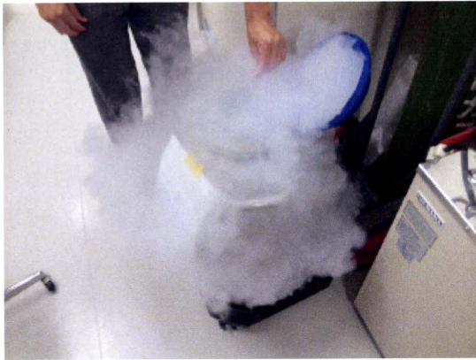
写真：液体室素に IC タグを入れての実験
