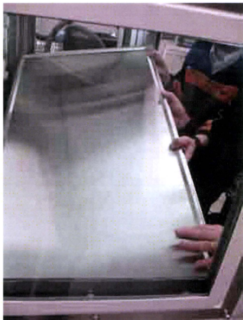
別添 2 4. 作業台底板の取り外し
