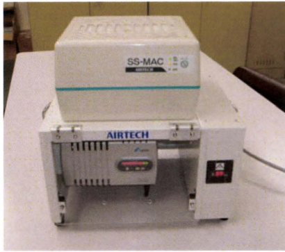
図4. エアロゾルモニターを用いた空気清浄度デモ機
