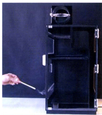
図2. クラスII生物学用安全キャビネット デモンストレーション用机上模型
