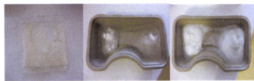
写真 9, 10, 11 : 液体物は専用の凝固剤を使用することで、固形物として廃棄できる。
