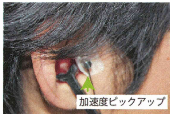
図 3 耳軟骨における振動加速度測定
