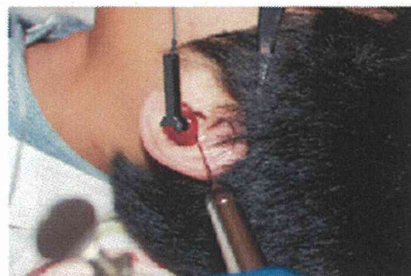
図4 (a) 接触条件・(b) 非接触条件における外耳道内の音圧測定
