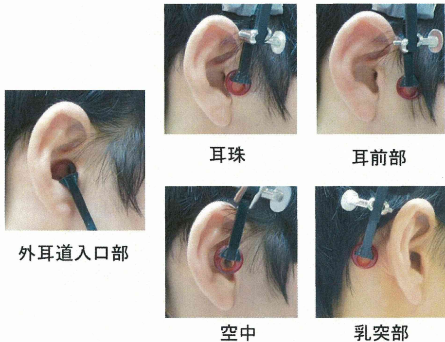
図2 軟骨伝導振動子の固定位置と固定方法
