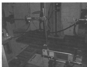
写真15 試験状況：リクライニング形（左：前方繰返し 右：後方繰返し）
