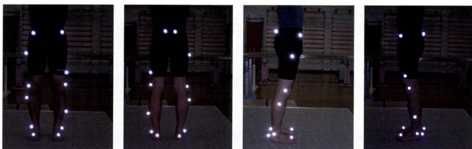
Fig. 3 赤外線反射マーカを貼付した状態（左より、正面、背面、右面、左面）
