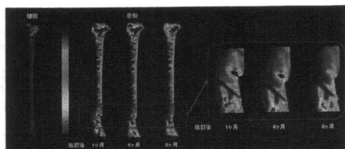
Fig. 5 100kgf 荷重時の最小主ひずみ分布 (左:健側脛骨全長、右:患側脛骨全長および遠位拡大図)
