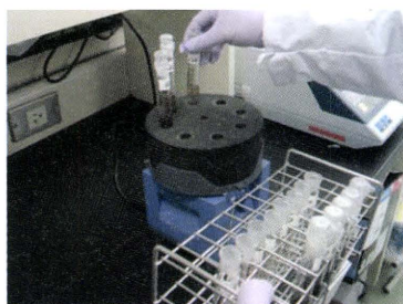
2. 抽出作業(クロロホルムによる液液抽出)
