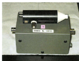
使用したUS振動子とマッチングボックス 口径10mm、ボディー径30mm 共振周波数: 497.7KHz 空冷式
