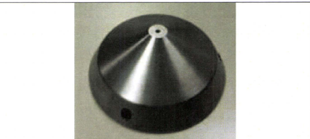
図2 局所拡大超高解像度撮像のためのタングステン製ピンホールコリメータ
