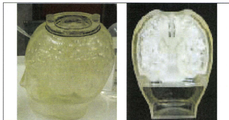
図3 評価に使用した3D脳ファントム。左は外観、右は断面。
